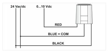
Fig. 7 Wiring diagram
