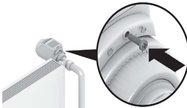
Hlavici lze zajistit na tělese ventilu šroubkem (ochrana před odcizením hlavice, šroubek v balení)
