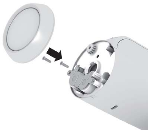
Pružinu baterie lze zajistit šroubky (ochrana před odcizením baterií, šroubky v balení)
